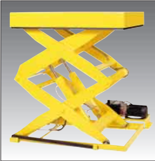
Heftafel met dubbele scharen, type EVL15-160, 2 ton draagkracht en uitgebreid hydraulisch aggregaat, ingezet in een automatisch stapelsysteem tijdens 2 ploegendienst.
