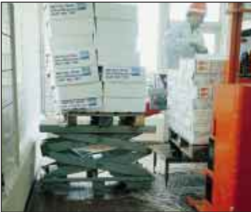
De heftafel met dubbele scharen, type EV10-188G en 1 ton draagkracht, in een verwerkingsbedrijf voor voedingswaren, maakt het mogelijk een groot aantal pallets te behandelen zonder rugklachten. Ergonomische heftafel.
